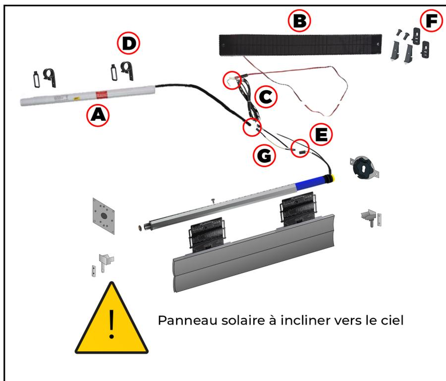
Fixer le support côté moteur et le support côté opposé bien au centre de chaque joue d'extrémité du coffre tunnel, de façon à ce que le tube soit bien horizontal.
